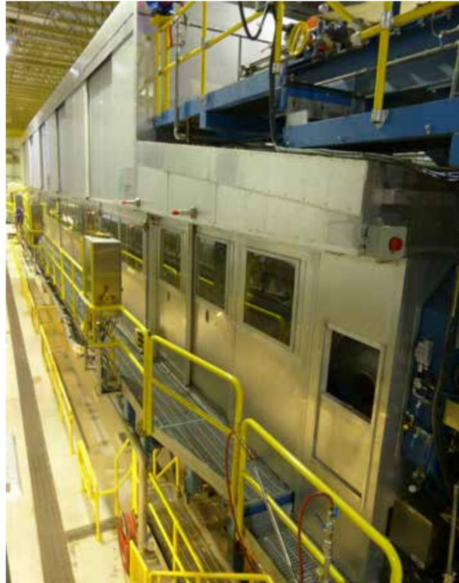
La sécherie, où le papier circule entre des rouleaux chauffés afin d'en évaporer l'eau
